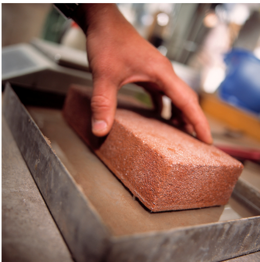
Meting wateropzuiging baksteen.
