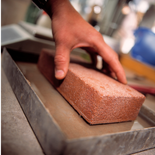
Meting wateropname steen.
